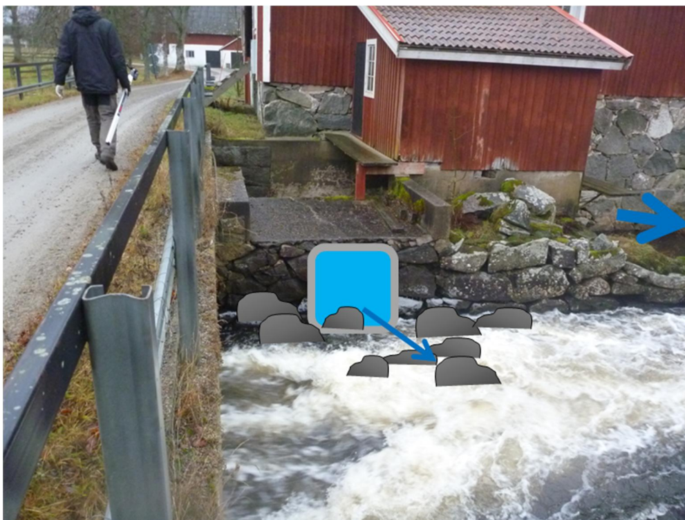
Figur 3. Skiss över tänkt mynning mot huvudfåran. Möjlighet till brädning och mintappning i den gamla utloppskanalen finns.
