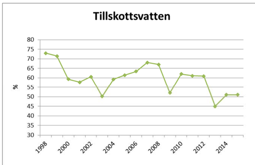
Figur 5. Ovidkommande vatten Lammhult avloppsreningsverk 1998-2015
