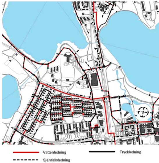
Befintligt ledningsnät VA
