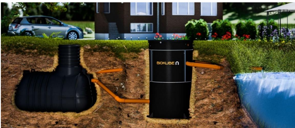
Bild 4.1.2b Illustration installation av minireningsverk
