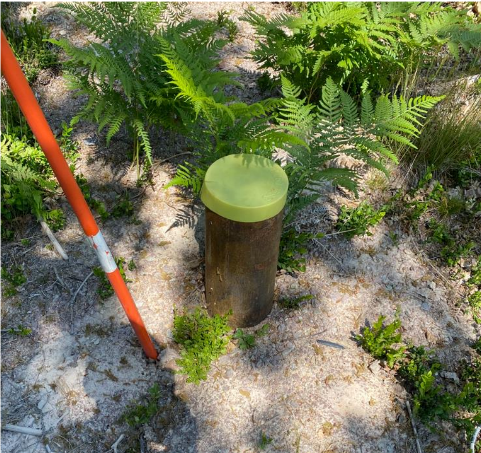
Figur 4. Bild på djupborrat grundvattenrör. © Sweco, 2023.
