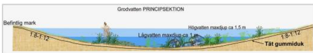
Figur 4. Principskiss tvärsnitt på utformning av ett grodvatten. Notera variationen i vattennivå samt den låga släntlutningen.
