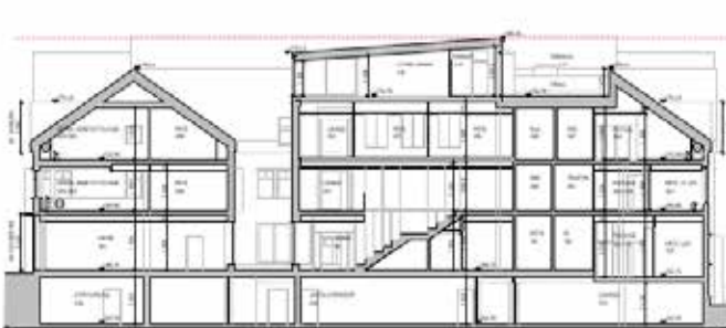
NY DP FÖRSLAG / sektion plushöjd +110,14 med hisstopp +110,77 (reducerad total byggnadshöjd med 1,66m exklusive hisstopp / 1,9m ovan bef. taknock)
