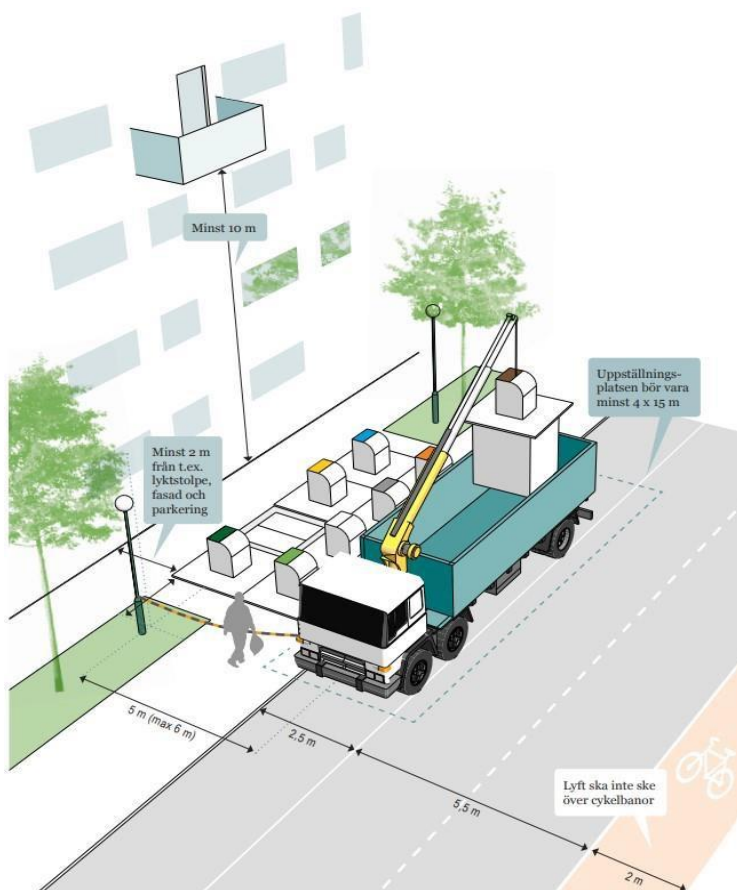
Bild 5 Exempel på hur det kan se ut vid tömning av botten tömmande behållare. Utdrag från Avfall Sveriges handbok avfallsutrymmen 2023. Bild: Sara Sundin, Ramboll.
